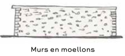
Murs en moellons
